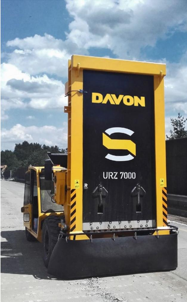
UNIVERSAL MOBILE MACHINE FOR DEMOLISHING CONCRETE SURFACES
